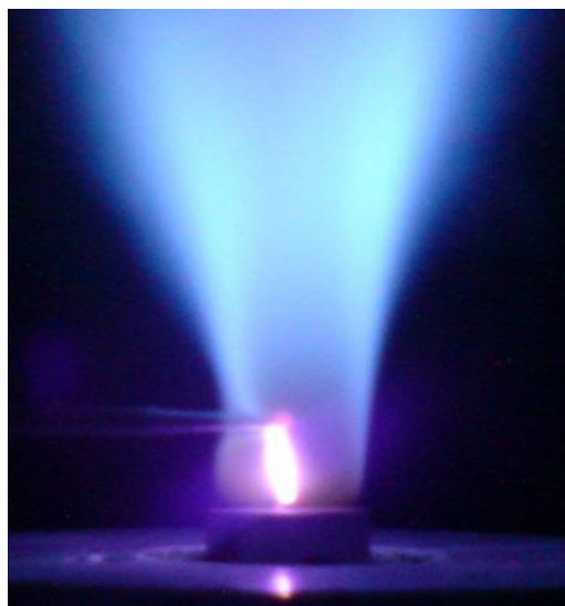
Figure 1 : Stabilisation de flamme pauvre propane-air par décharge plasma nanoseconde
